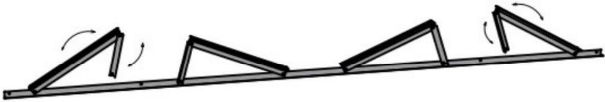
Vormontierte Dreiecke aufklappen und hintere Stütze für befestigen. Alle Außensechskantschrauben M8x20 mit Sperrzahnmutter M8 fixieren.
