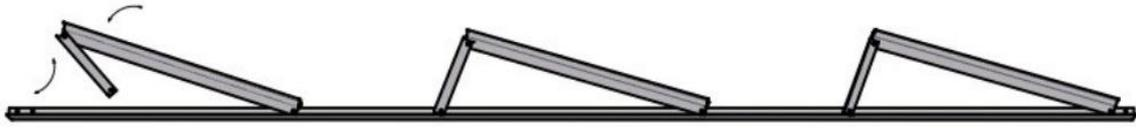
Vormontierte Dreiecke aufklappen und hintere Stütze für befestigen. Alle Außensechskantschrauben M8x20 mit Sperrzahnmutter M8 fixieren.
